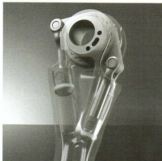
Bild 9 den Verspleueln FEV wird exzentriert um den Kolben angeordnet. Auge hydraulisch angesteuert.
